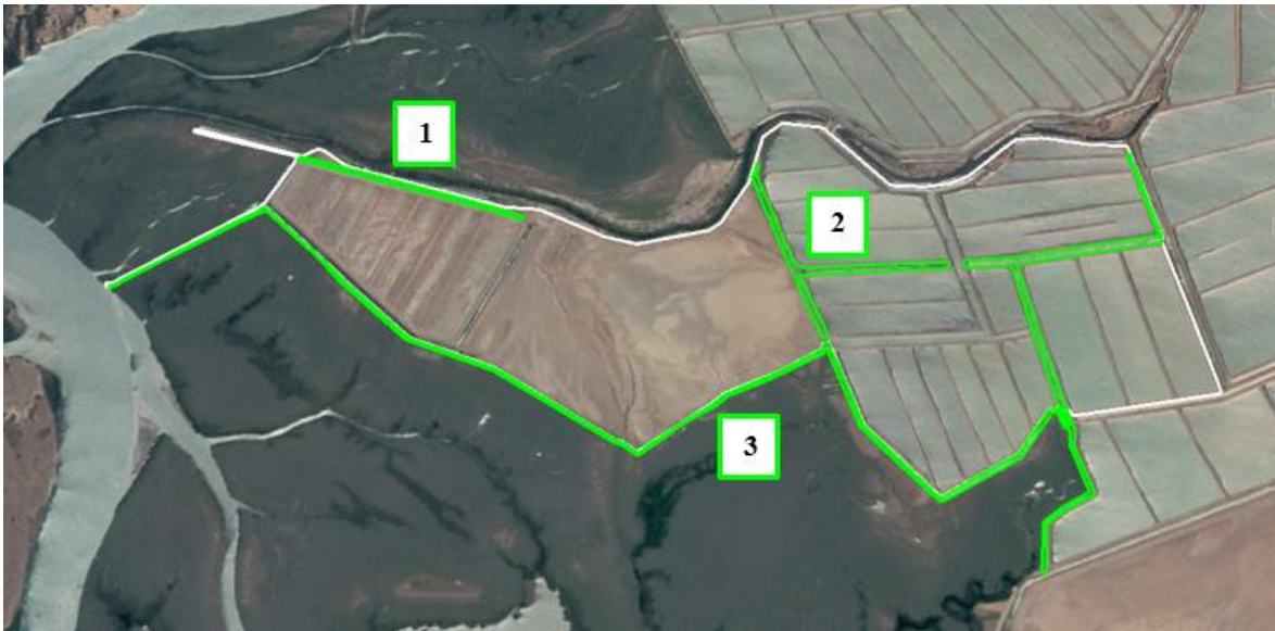
Ilustración 37.-Drenes para la descarga de agua
