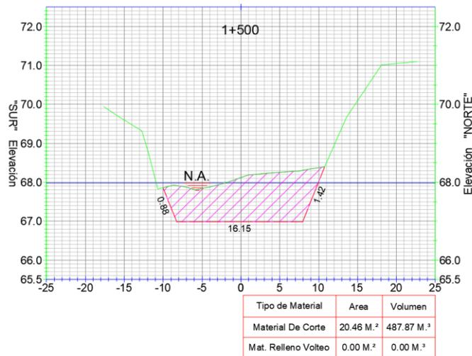
La línea verde representa el terreno natural, lo achurado en color magenta es la sección o cubeta que se formara con el corte (extracción del material, dragado), y las medidas son las indicadas en cada una de ellas.
