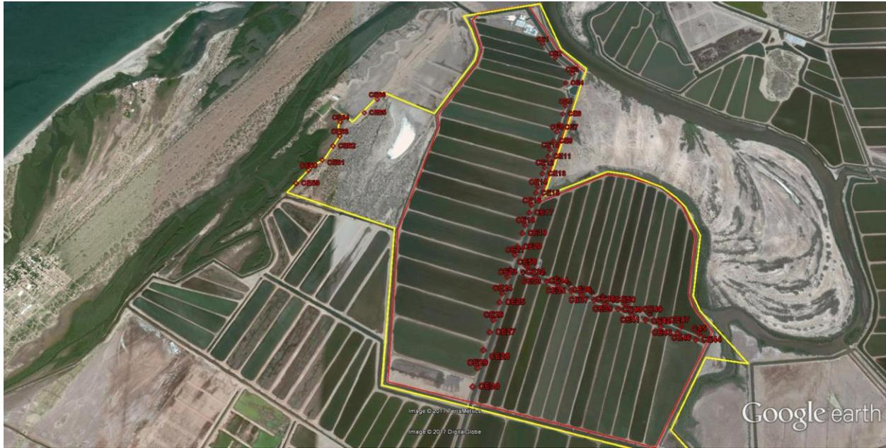
Figura 11. Distribución de Compuertas de entrada a lo largo de la estanqueras de Acuicola Santa Fe Sección A, son promedio una por cada estanque (interior, en estanque y exterior en reservorio) se incluyen compuertas en reservorios.
