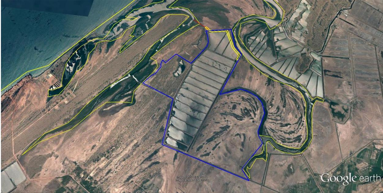
Figura 21. Canal de llamada (Poligono amarillo dentro de la poligonal), apertura antigua para conectar el canal de llamada con aguas mas cercanas a la boca de entrada al Golfo de California.
