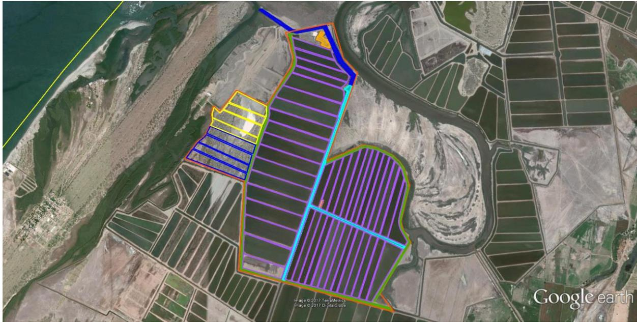
Figura 08. Infraestructura actual de granja acuícola Santa Fe Sección A al centro se observa el canal reservorio con el acomodo en cuatro módulos: 1 (1-18), 2 (19-31), 3 (32-44) y 4 (45-48) estanques a cada lado, con un total de 48 estanques, 4 estanques lagunas de oxidación canales de aguas usadas en la periferia y el canal de llamada que abastece a la granja.
