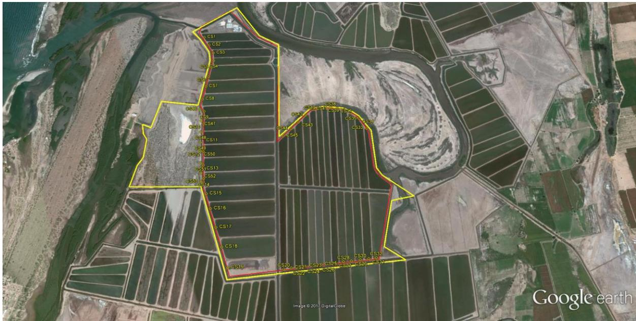
Figura 12. Distribución de las compuertas de salida a lo largo de la estanqueras de Acuícola Santa Fe Sección A, generalmente una por cada estanque (interior, en estanque; exterior, canal de salida) se incluyen compuertas en reservorios.
