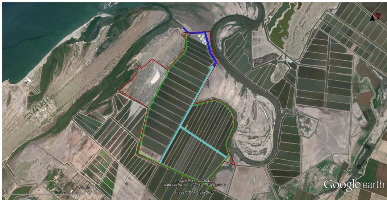
Figura 09. Sistema de canales de llamada (azul fuerte), reservorio (azul bajo) y canales de salida color verde ceituna en acuícola Santa Fe Sección A.
