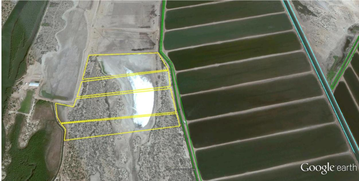
Figura 17. Laguna de sedimentación para disminuir la carga orgánica y otro detritus del camarón dentro de las instalaciones de la granja acuícola Santa Fe Sección A.
