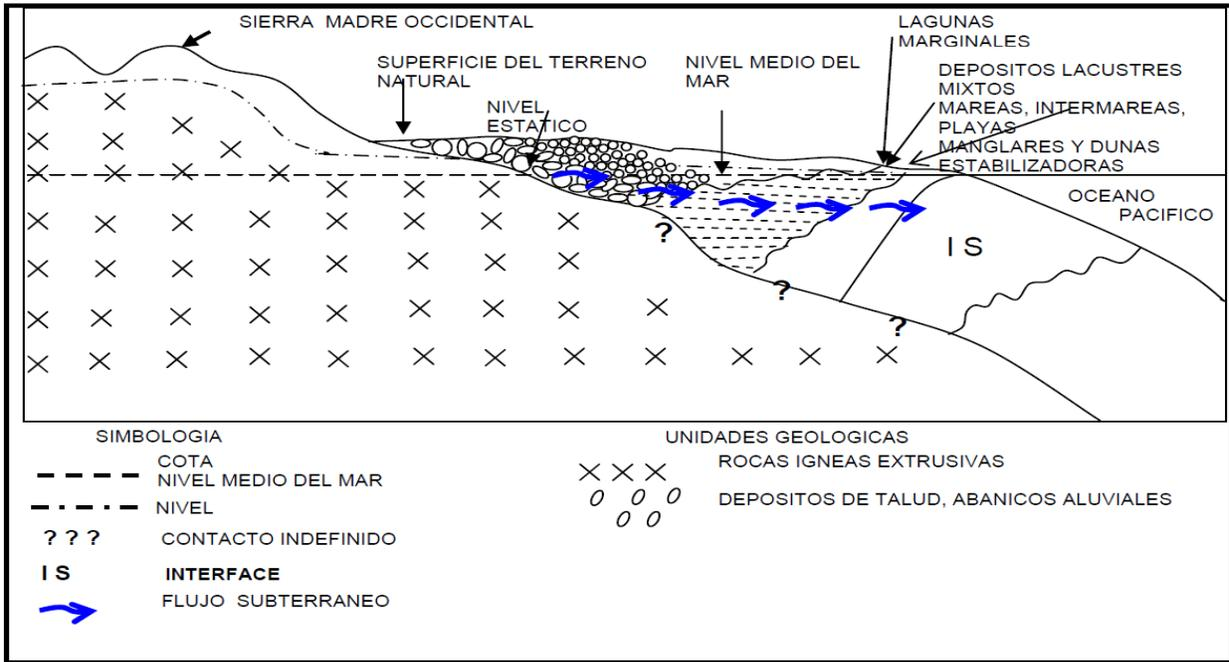
Figura 41. Sección esquemática de la estructura de las aguas subterráneas en el Acuífero 2514 El Carrizo, al norte de Ahome, Sinaloa.
