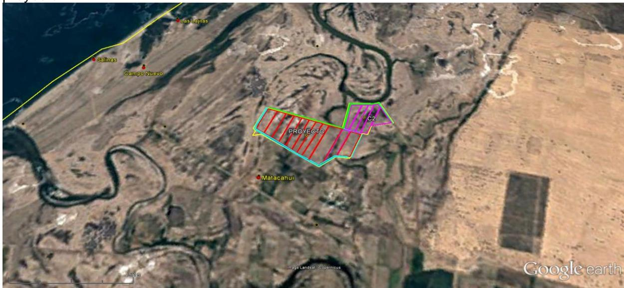
Figura 16. Canales naturales del Estero El Manglón, la forma del ramal natural se observa en imágenes históricas del año 1984 y las poligonales actuales de los canales de: llamada (azul), reservorios (azul turquesa) y drenes de salida (color verde), lo que demuestra que la infraestructura hídrica de la granja acuicola Santa Fe Sección B se ajustó a los canales existentes y solo se conectó de una pequeña sección (línea azul) con el estero El Manglón.
