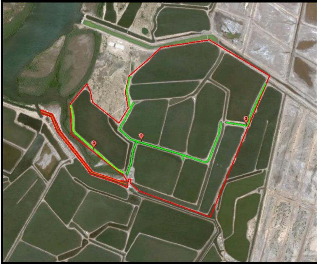
Figura II.3 Distribución de las secciones de drenes de descarga
