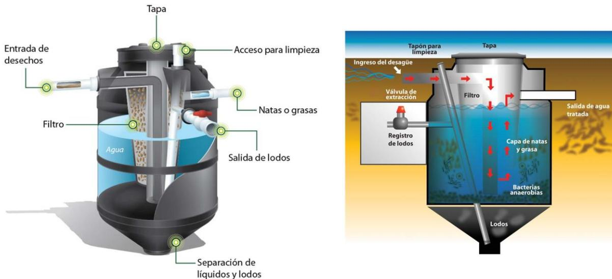
Ilustración 28.- Detalle Biodigestor
