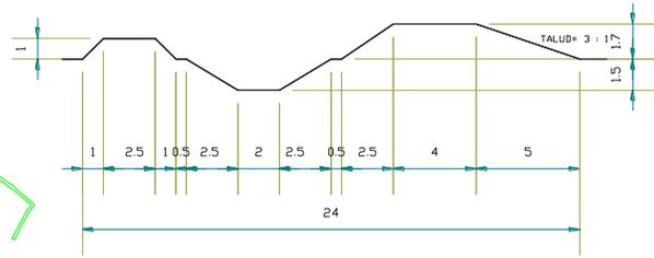
Ilustración 12.- Dren de descarga
