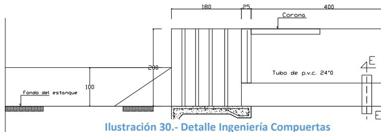
El llenado de los estanques se realiza durante el resto del día. El sistema de bombeo es diseñado a partir del reservorio de almacenamiento, con compuertas de entrada capaces de dejar fluir el agua por gravedad. Drenar los estanques por la mañana y operar las bombas para rellenar el reservorio por las tardes o durante las mareas altas es una manera eficiente de operar los estanques.
