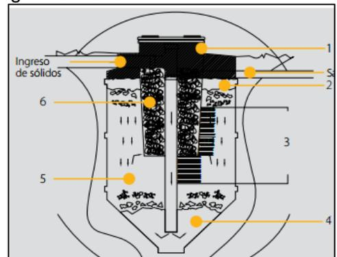
Ilustración 29.- Mecanismo Biodigestor
