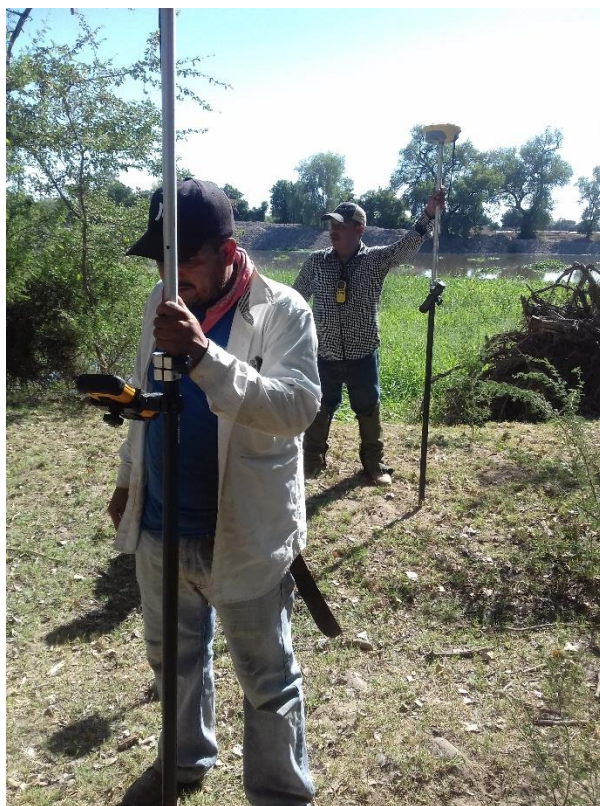
Imagen VIII.2. Personal realizando el levantamiento topográfico del sitio del proyecto
