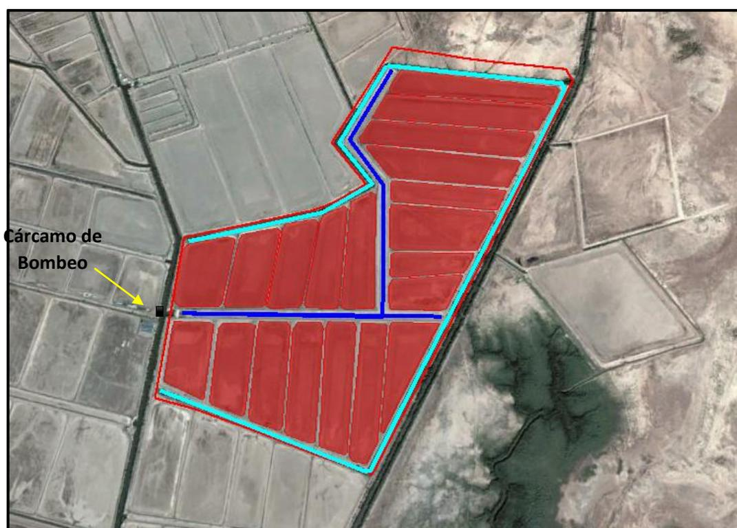
**Figura II.1.** Distribución de estanques ( ◆ ), reservorio ( — ), drenes ( — ) y flujo de agua ( → ) en la granja El Macapule SCL de CV.
