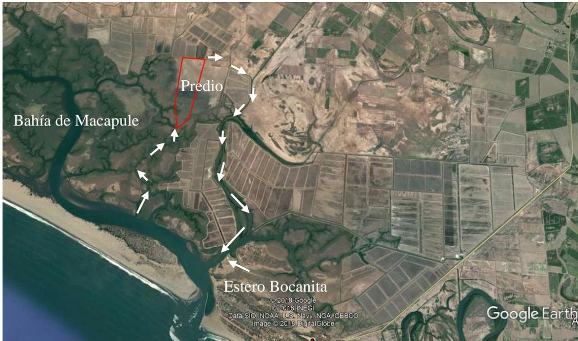
Mapa de google earth, donde se muestra el trazo de la toma de agua y de la descarga del agua residual de los estanques.
