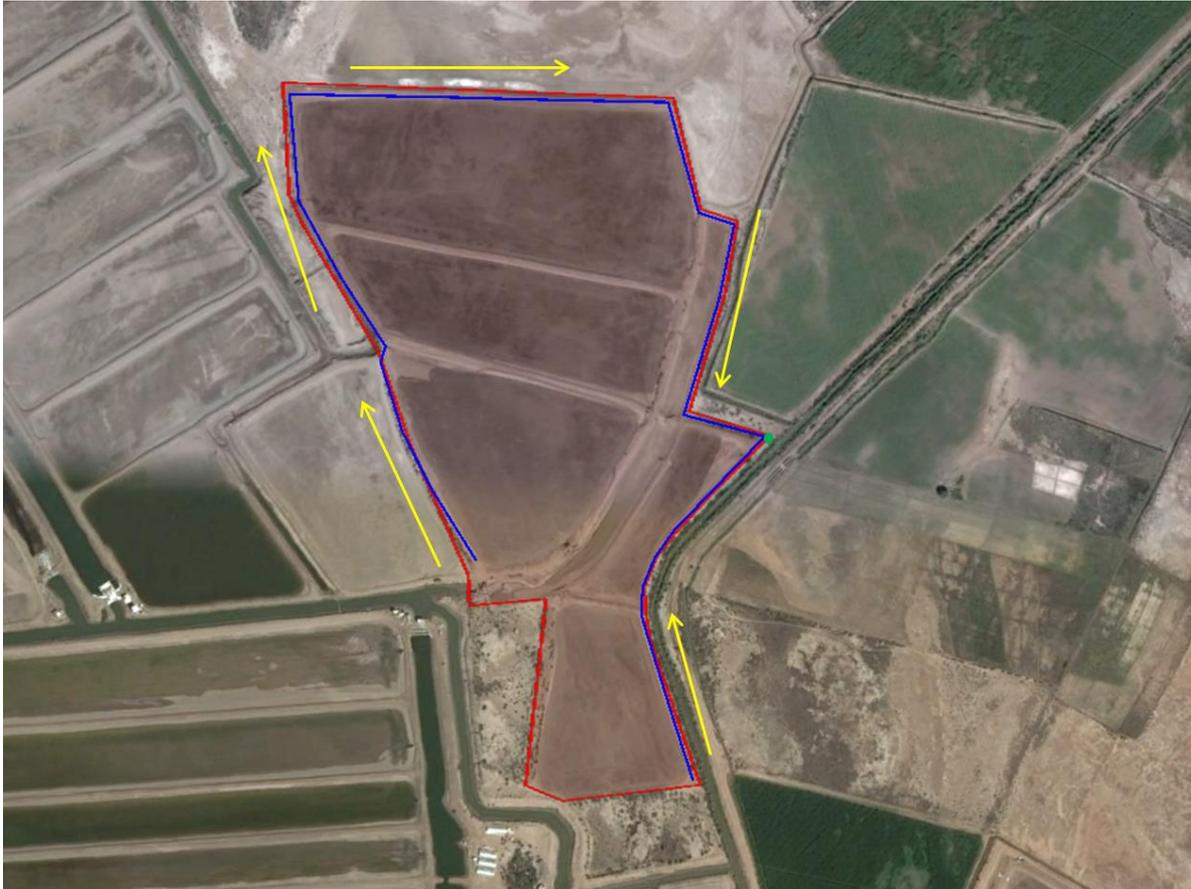
**Figura II.6** Drenes con sus flujos y puntos de descarga
