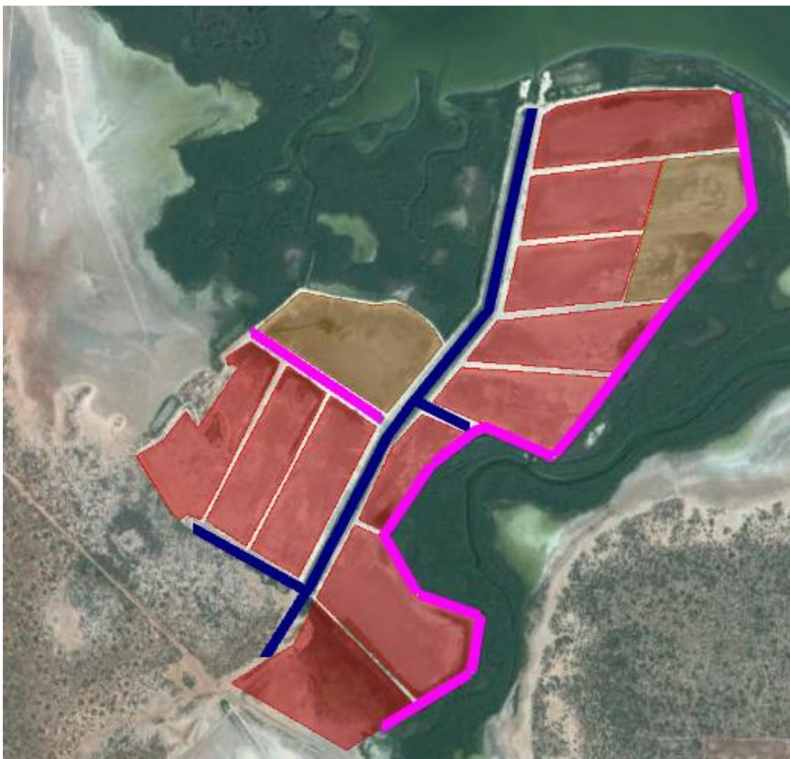
Figura II. 1 Distribución de estanques ( ♦ ), lagunas de oxidación ( ◆ ), reservorio ( — ) y drenes ( — ) en la granja Acuícola SCP y Servicios Camarón Plateado.
