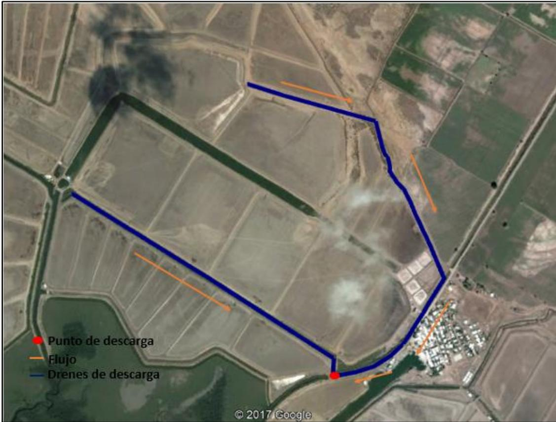
Figura II. 9 Drenes con sus flujos y puntos de descarga
