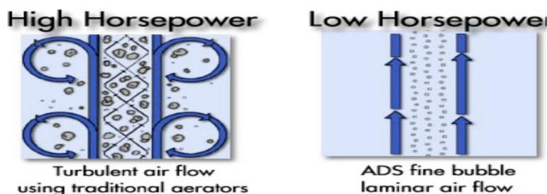
Figura VI.2. Ventajas del ADS sobre aireación convencional.
