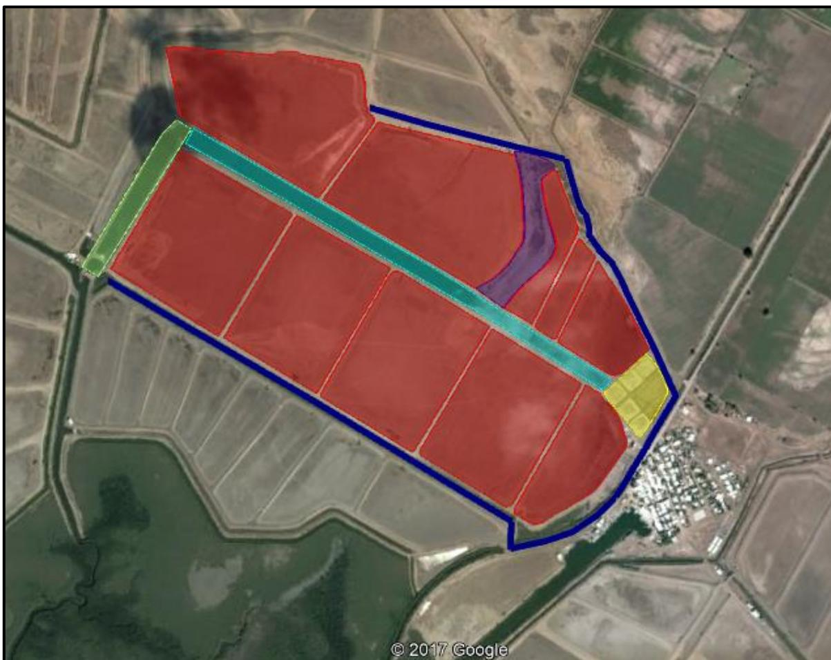
**Figura II.1.** Distribución de estanques (♦), criadero (■), canal de llamada (—), reservorio (—) y drenes (—) en la granja Zaratajoa Acuícola S.A de C.V.
