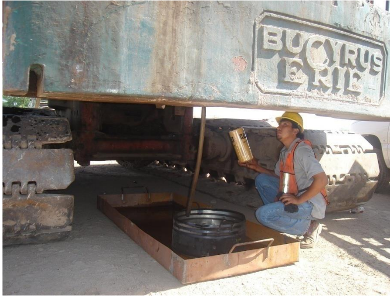
Imagen No. 26.- Charolas utilizadas para derrames accidentales.
