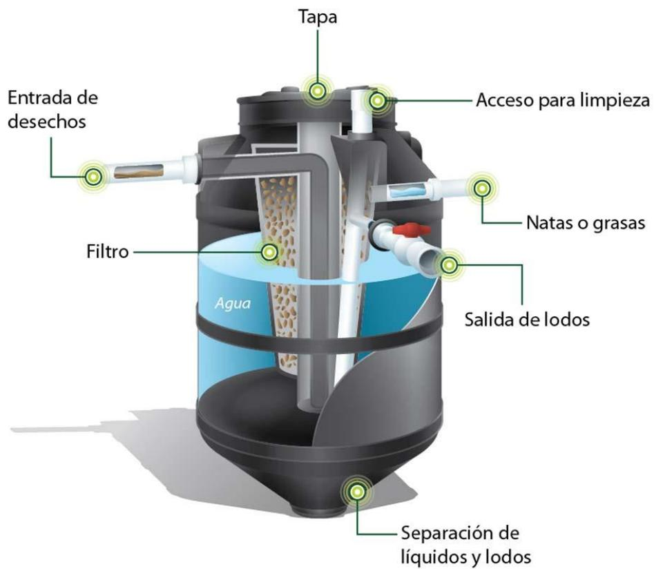
Estructura del biodigestor Rotoplas modelo RP-1300.
