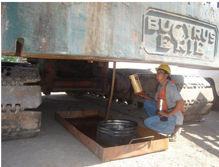
Imagen No. 31.- Charolas metálicas a utilizar, con una medida de 1.5 de largo x 1.00 de ancho.
