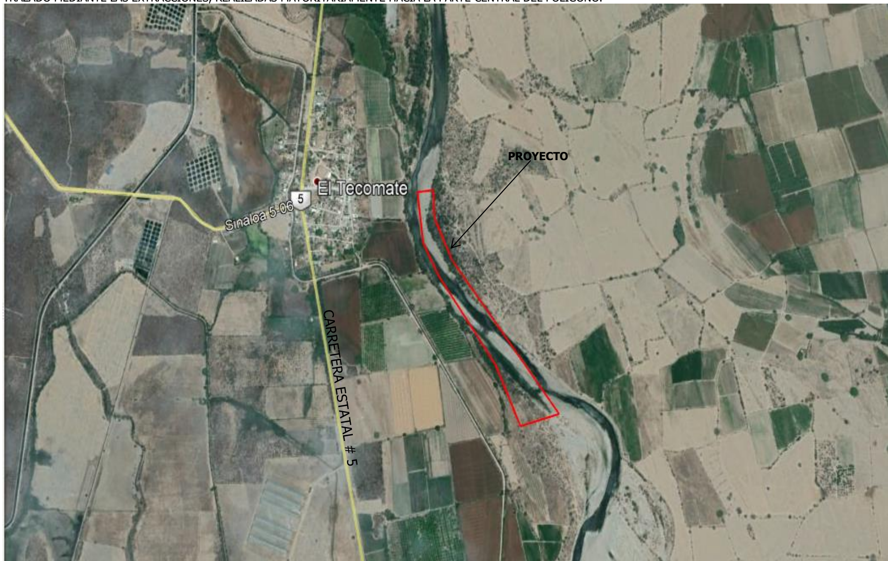
FIGURA 9. FOTO SATELITAL. - SE MUESTRA EL ÁREA DEL RÍO PRESIDIO, AL NOROESTE DE LA COMUNIDAD EL TECOMATE. POR LA MARGEN IZQUIERDA EN ESA MISMA DIRECCIÓN PUEDE VERSE QUE LA DIVAGACIÓN DEL CAUCE HA RETIRADO COMPLETAMENTE LA CORRIENTE DE AGUA. EL PROYECTO BUSCA ENCAUZARLO CON UN EJE PILOTO TRAZADO MEDIANTE LAS EXTRACCIONES, REALIZADAS MAYORITARIAMENTE HACIA LA PARTE CENTRAL DEL POLÍGONO.
