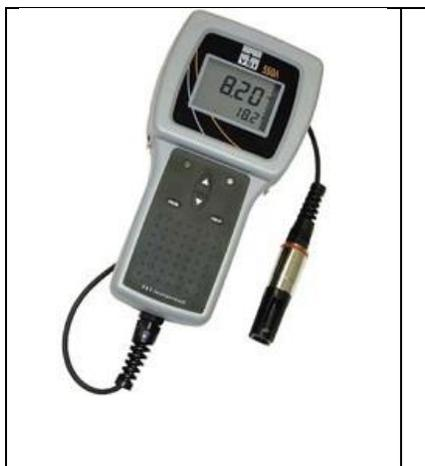
Figura 8. Oxímetro de campo con sonda.
