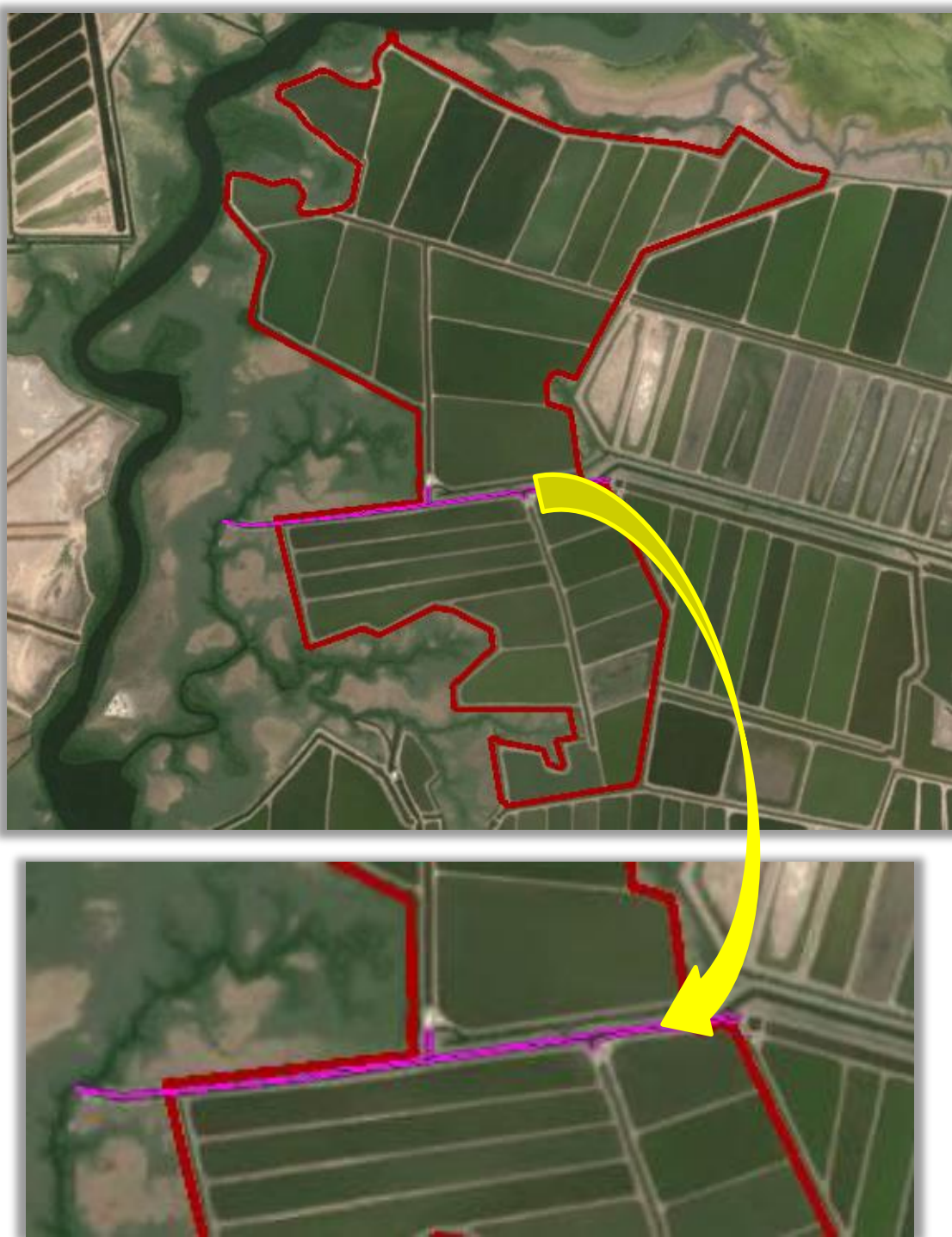
Ilustración 26.- Toma de agua del estero “Cangilones”, canal de llamada en color rosa.
