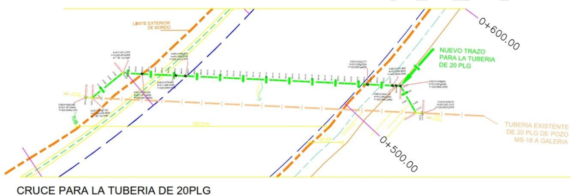
Figura II.13. Ubicación del cruce de tubería de 20"
