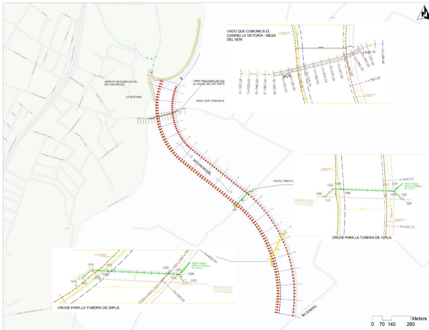
Figura II.8.- Obras asociadas al bordo de protección.
