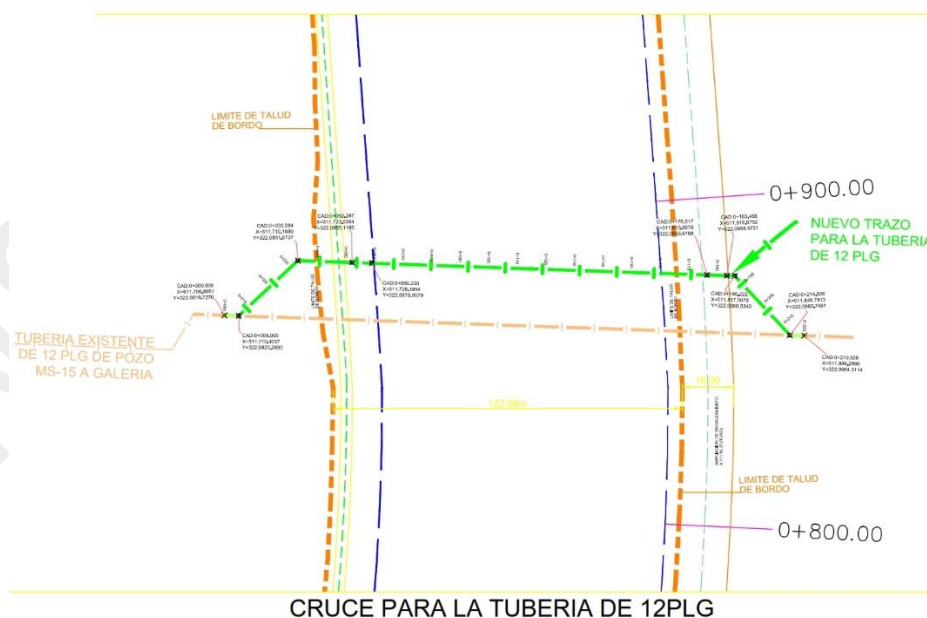
Figura II.14. Ubicación del cruce de tubería de 12"
