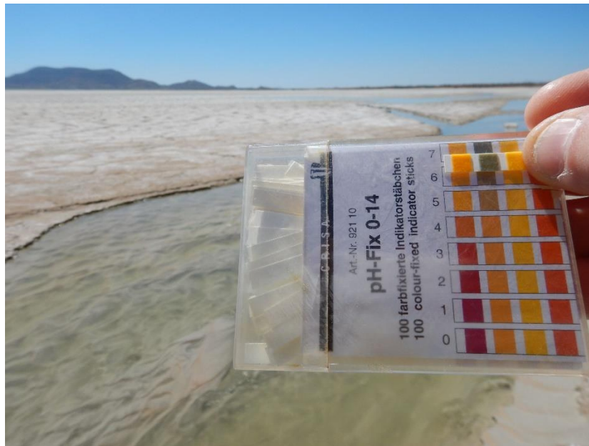
Figura 4.23. Valores de pH de 6 a 7 unidades, medido en el agua de la presa de jales, al Este del SA.
