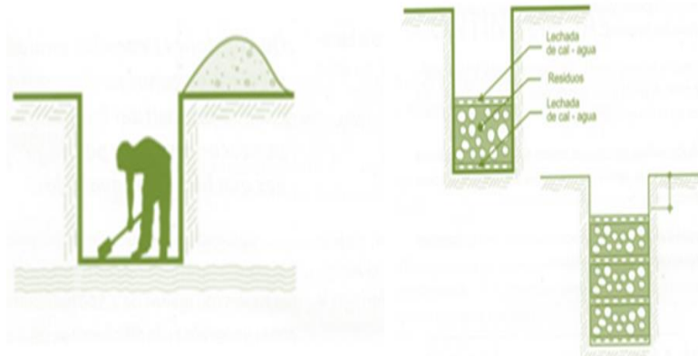
Figura 33. Construcción de las fosas de Mortalidad.
