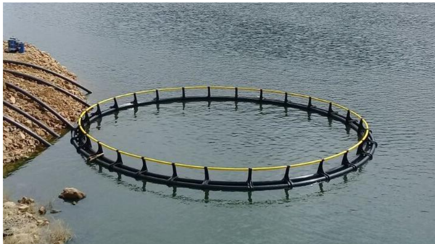
Figura 29. Características de la estructura de las jaulas Circulares a construir en el proyecto.
