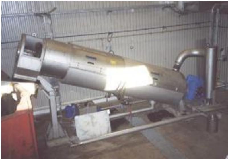
Imagen 7. Planta de prensado de lodos tipo tornillo Reactor de floculación.
