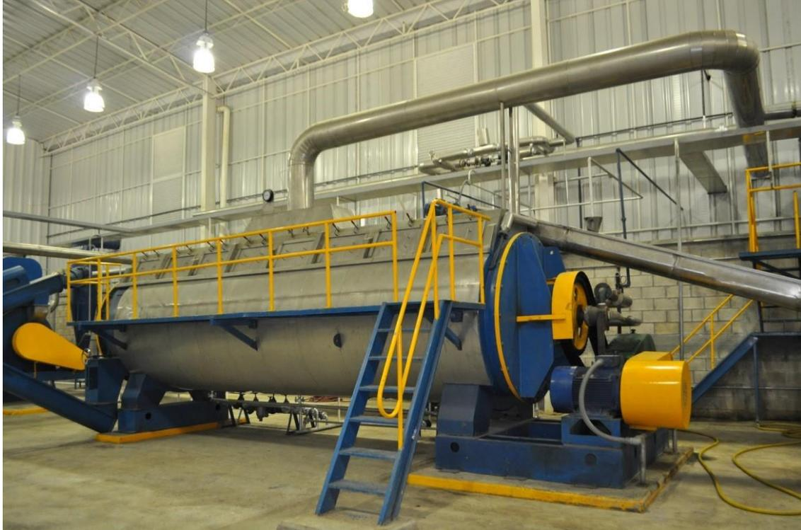
La fase sólida se transporta hacia el **secador** mediante un tornillo helicoidal para realizar el secado hasta alcanzar la humedad requerida en el producto final y obtener la harina de pescado. El proceso de **secado** consiste en deshidratar la harina de pescado hasta un **7-10%** de humedad en la harina.
