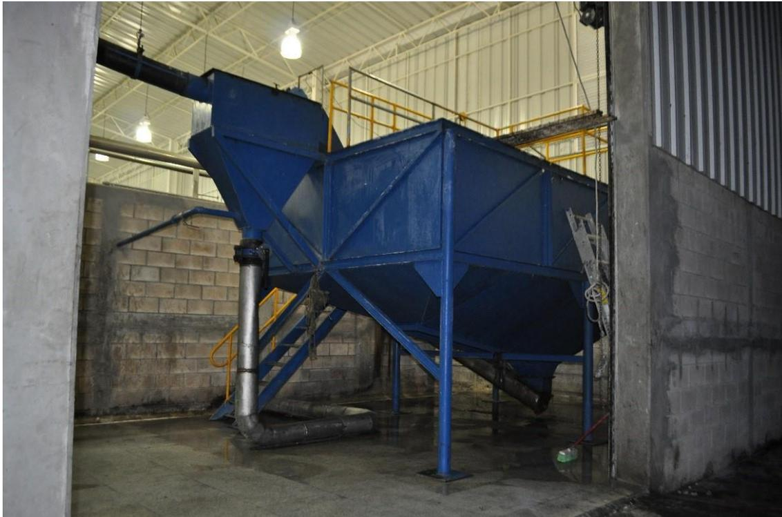
Una vez pesada la materia prima (Subproducto y desechos), esta se deposita por medio de una grúa de techo a un elevador cilíndrico metálico con tornillo sin fin, el cual transporta la materia prima del área de recibo al área de proceso donde se introduce la materia a un cocinador.
