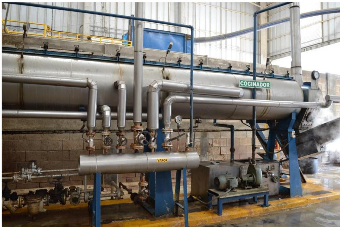
Tanque cilíndrico de acero inoxidable con un tornillo sin fin que mueve el producto a través de una tubería de vapor a 0.85 MPa y 105 °C, durante un proceso continuo de 4.5 min terminando el producto en el expeller o prensa de extracción de líquidos.
