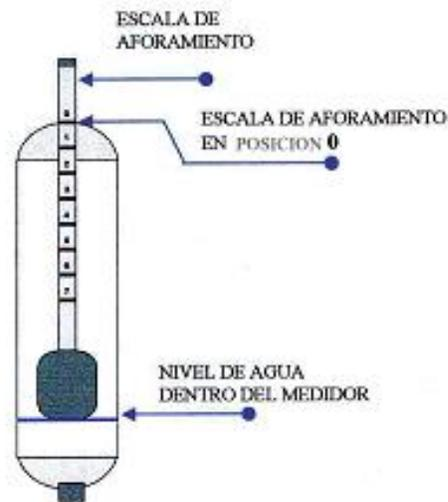
Imagen 5. Diagrama de Medidor de Caudal.
