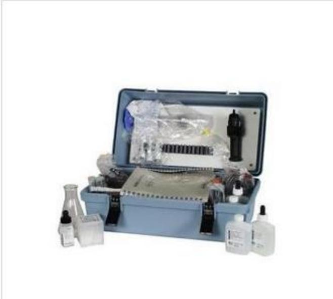
KIT DE PRUEBA DISEÑADO PARA AGUA DULCE UTILIZA REACTIVOS EN CARTUCHOS DESECHABLES DE FÁCIL LECTURA DIGITAL. ACIDEZ, ALCALINIDAD, DE 100 A 4,000 MG/L; AMONIACO: DE 0 A 3 MG/L; DIÓXIDO DE CARBONO: 10 A 100 MG/L; CLORURO: DE 10 A 160 MG/L, OXÍGENO DISUELTO: 0 A 10 MG/L; DUREZA DE 100 A 4,000 MG/L; NITRITOS: 0 A 0.5 MG/L; PH DE 4 A 10; TEMPERATURA: -30 A 120 °F. PESA 6 KG.
