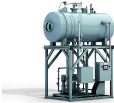
Beneficio operacional; Dispositivo que por el aumento de presión y temperatura del agua de alimentación a caldera permite eliminar el bióxido de carbono y remover hasta el nivel más bajo posible la cantidad de Oxígeno presente en el agua, para así evitar la corrosión en el sistema, esto independientemente de variaciones en las condiciones de operación y carga.
