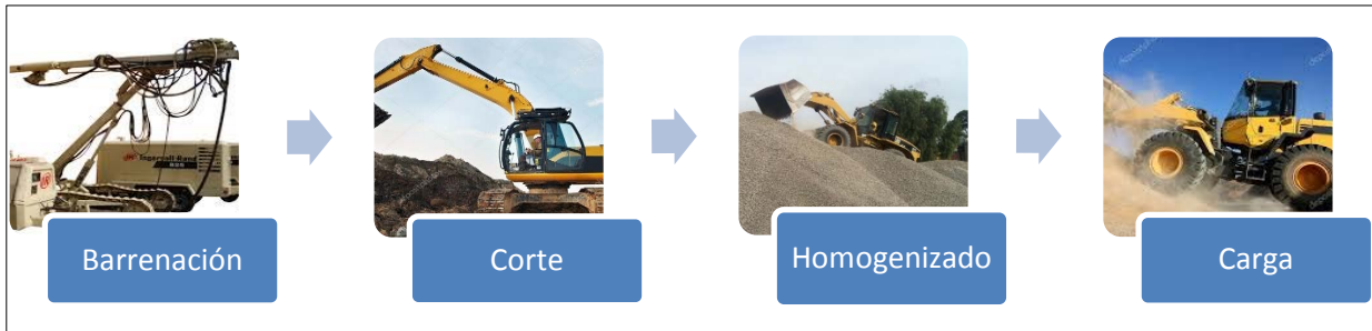
Ilustración 8.- Proceso de operación del proyecto minero “La Purísima”
