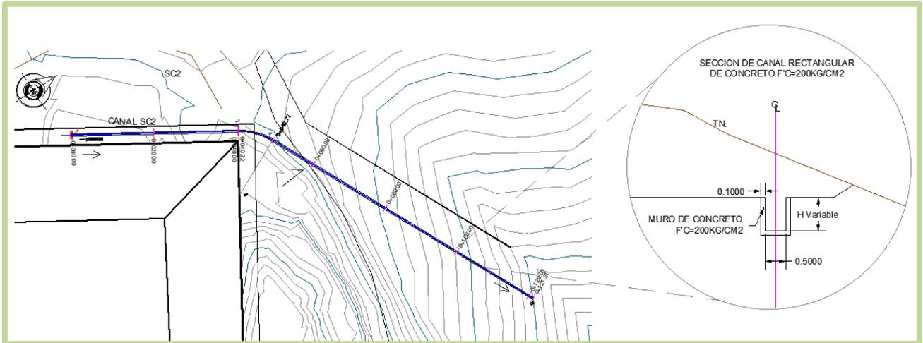
Figura 2-9. Planta y sección de canal SC2
