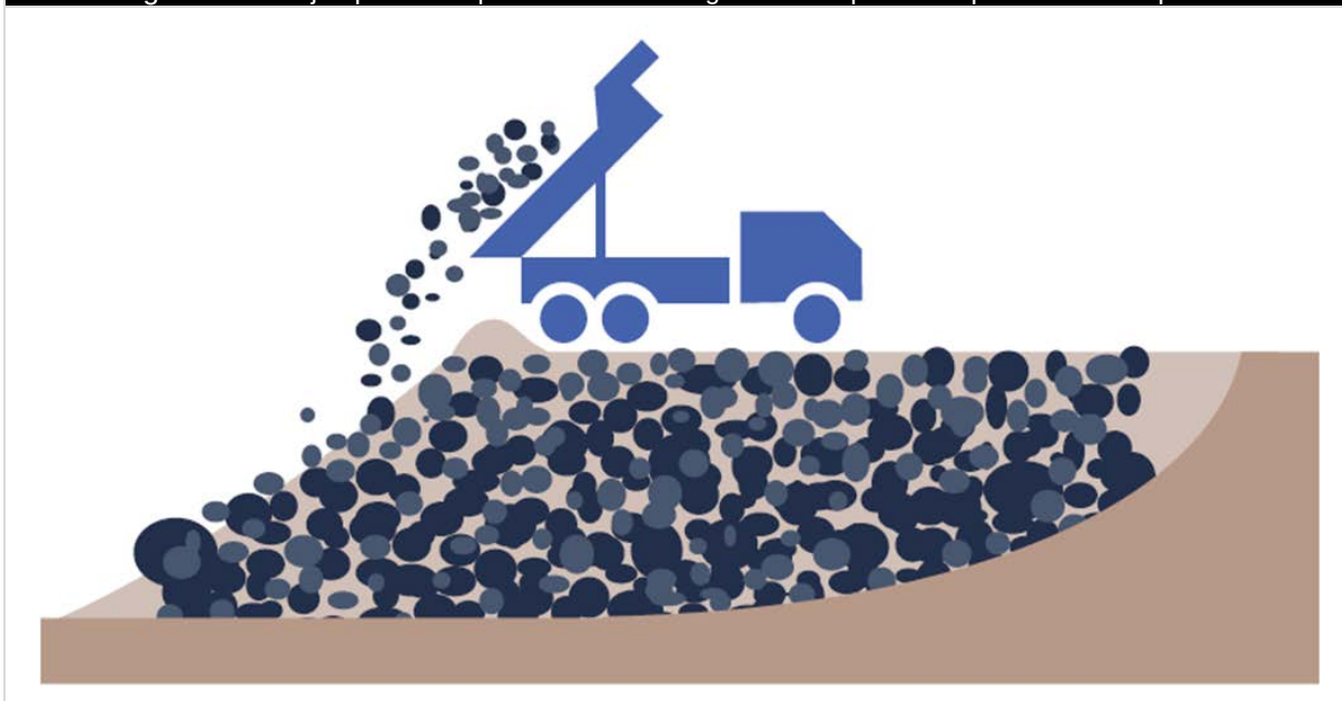
Figura II- 25. Ejemplo de la operación de descarga en los depósitos superficiales de tepetate.
