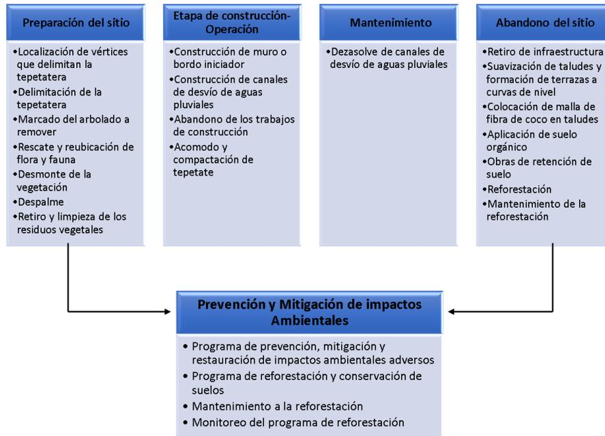
Figura II-1. Diagrama de flujo de las principales etapas de la obra
