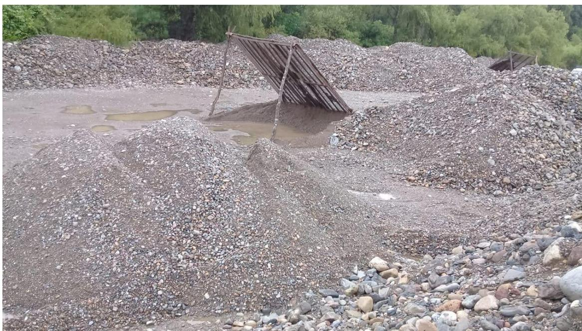
**Figura 58.- Área de cribado y lavado de material pétreo**
