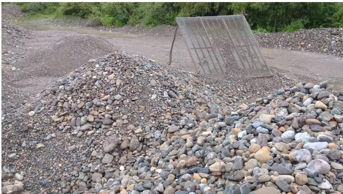
**Figura 59.- Separación de material pétreo con criba manual.**
