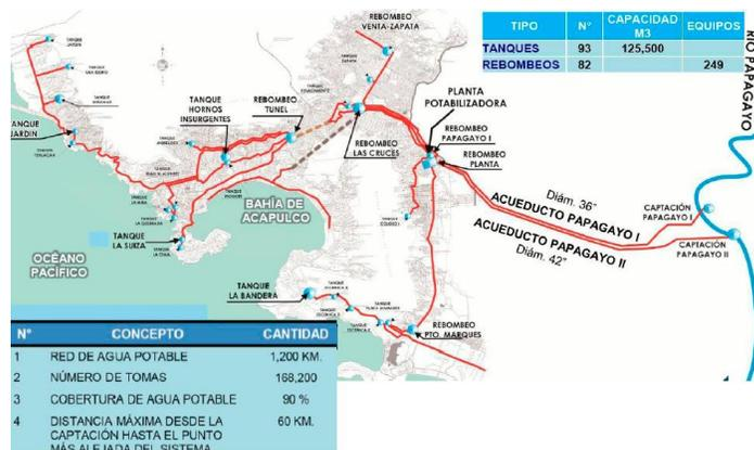
FIGURA 26. SISTEMA HIDRÁULICO GENERAL DE ACAPULCO
