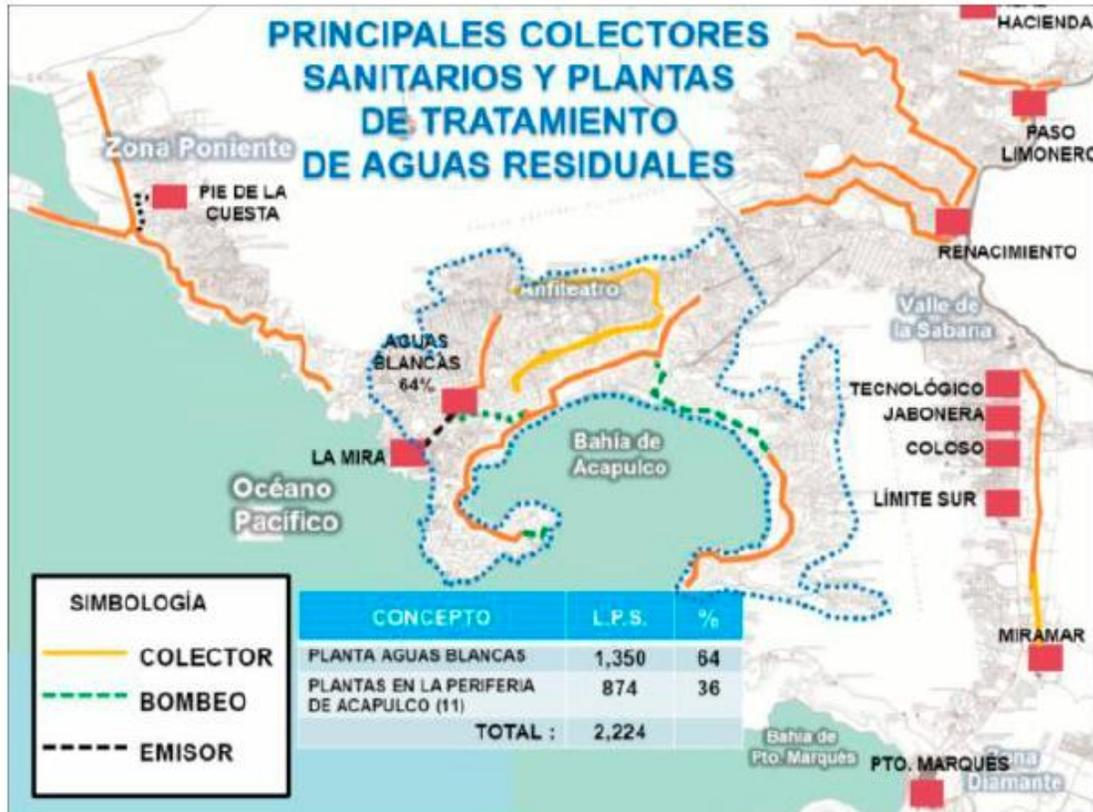
FIGURA 29. PRINCIPALES COLECTORES SANITARIOS Y PLANTAS DE TRATAMIENTO DE AGUAS RESIDUALES
