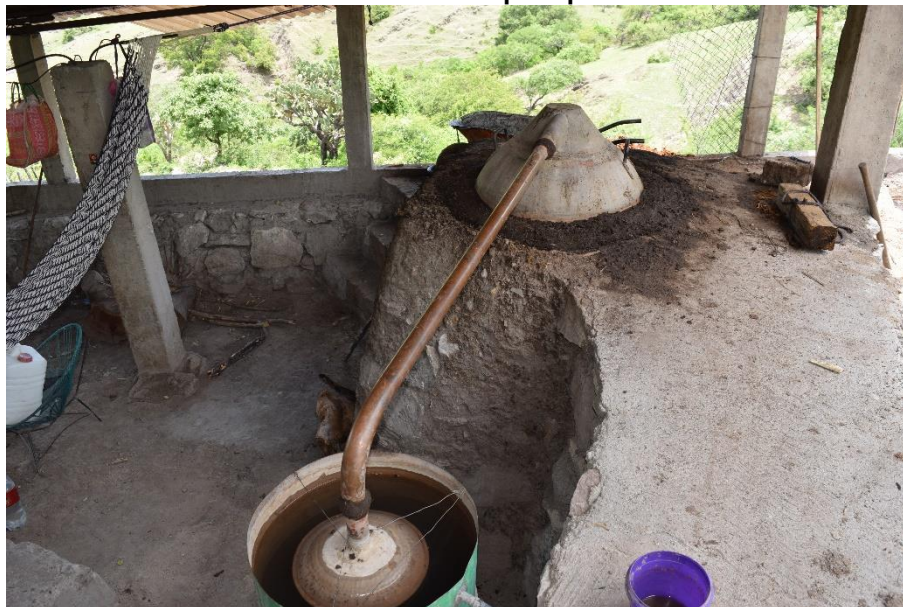
Foto 7. Proceso de destilación para producir el mezcal.
