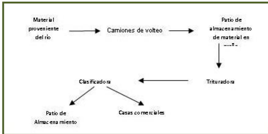
El área de extracción del material pétreo tiene una superficie de 3600.00 m<sup>2</sup>, dando un volumen para explotar de 1,584.00 m<sup>3</sup> por año, y se tiene programado explotar el sitio por cinco años dando un total de 7,920.00 m<sup>3</sup>.
