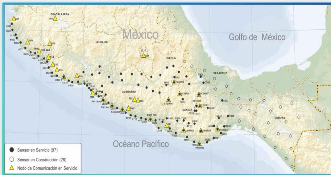
**Imagen 24 Red del sistema de alerta sísmica de México**
