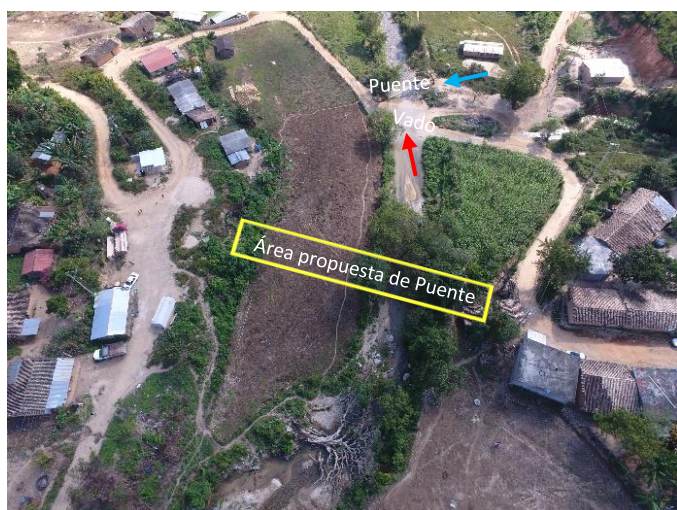
Imagen 7. Fotografía aérea Aguas Abajo del área propuesta del Puente el Coyul, se puede observar con la flecha roja el cruce del río mediante el vado, mientras que la azul señala el puente peatonal colgante de madera inoperante.
