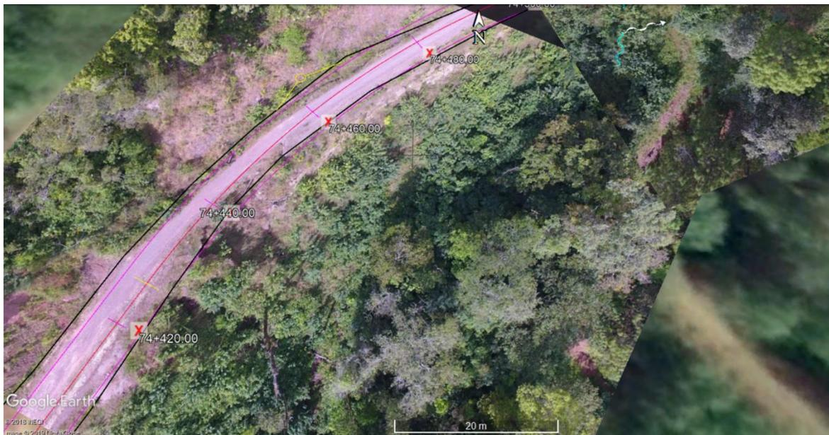
Fotografía 13. Vista aérea del Km 74+400 al 74+490, en el cual se puede apreciar en color rojo el ancho de corona de 7 metros que se pretende pavimentar; nótese como en un tramo de casi 90 metros lineales no se encuentra vegetación forestal primaria dentro del camino.
