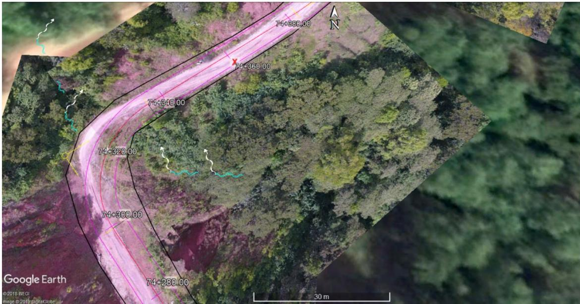
Fotografía 12. Vista aérea del Km 74+280 al 74+390, en el cual se puede apreciar en color rojo el ancho de corona de 7 metros que se pretende pavimentar; nótese como en un tramo de casi 110 metros lineales no se encuentra vegetación forestal primaria dentro del camino.
