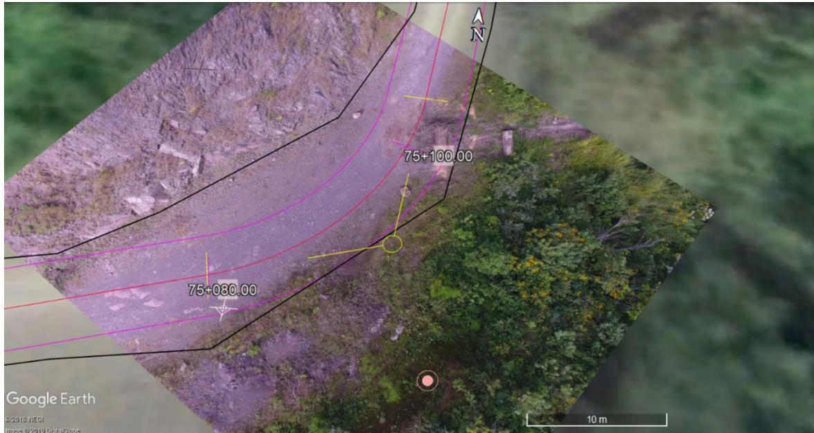
Fotografía 17. Vista aérea del Km 75+070 al 75+100, en el cual se puede apreciar en color rojo el ancho de corona de 7 metros que se pretende pavimentar; nótese como en un tramo de casi 30 metros lineales no se encuentra vegetación forestal primaria dentro del camino, solo arbustos y hierbas en los laterales.
