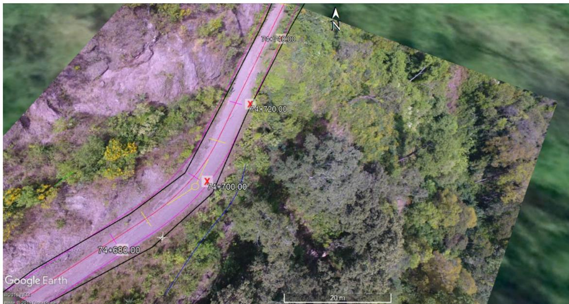
Fotografía 15. Vista aérea del Km 74+600 al 74+750, en el cual se puede apreciar en color rojo el ancho de corona de 7 metros que se pretende pavimentar; nótese como en un tramo de casi 150 metros lineales no se encuentra vegetación forestal primaria dentro del camino, solo arbustos y hierbas en los laterales.
