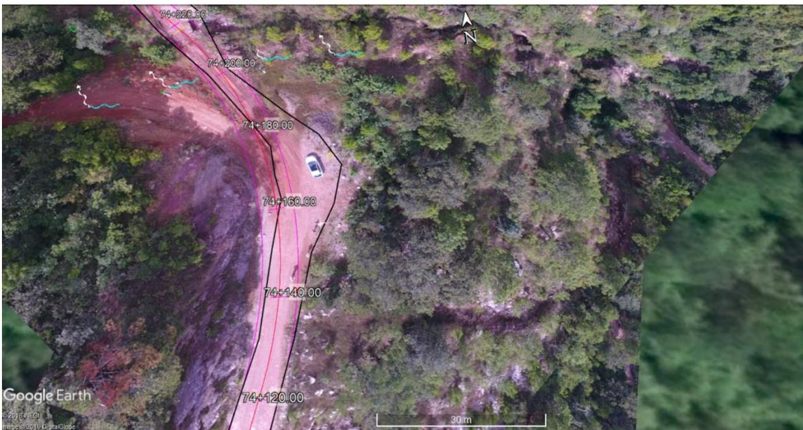
Fotografía 11. Vista aérea del Km 74+110 al 74+220, en el cual se puede apreciar en color rojo el ancho de corona de 7 metros que se pretende pavimentar; nótese como en un tramo de casi 110 metros lineales no se encuentra vegetación forestal primaria dentro del camino.
