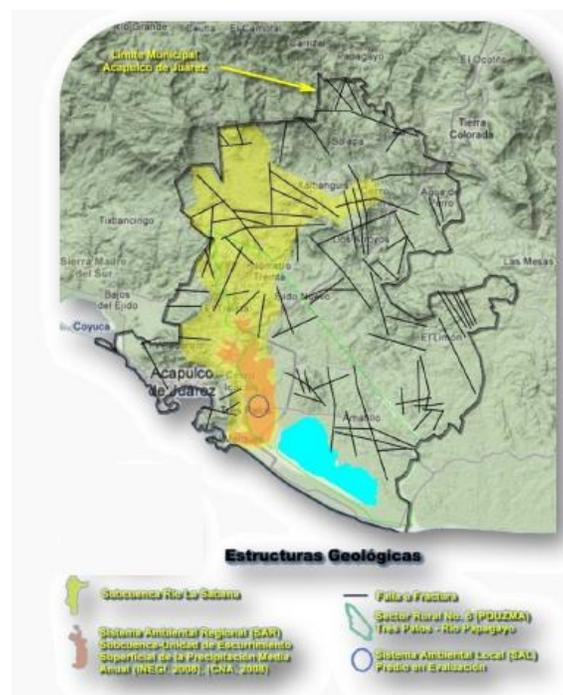
**Imagen 18 Fallas y fracturamiento**
