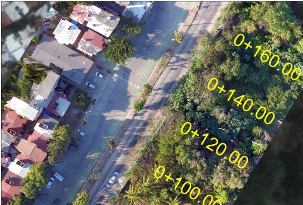
Fotografía 14. Vista aérea tipo plano del Km 0+100 al 0+160, en el cual se puede apreciar en color verde el ancho de corona que se pretende ampliar; nótese como en un tramo de casi 60 metros lineales no se encuentra vegetación forestal primaria dentro de la vialidad.
