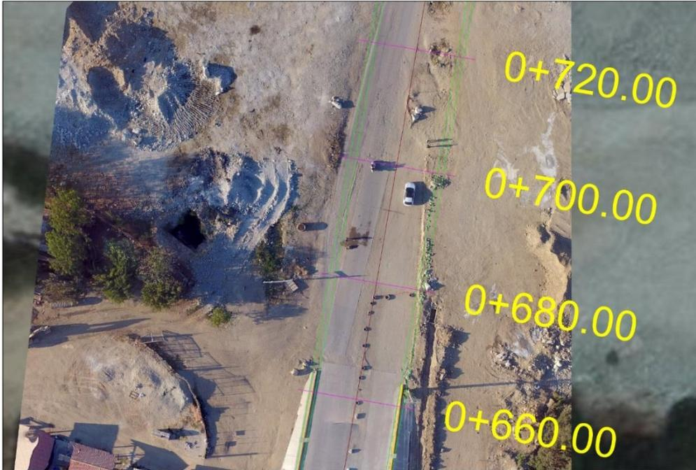
Fotografía 19. Vista aérea del Km 74+870 al 74+925, en el cual se puede apreciar en color rojo el ancho de corona de 7 metros que se pretende pavimentar; nótese como en un tramo de casi 55 metros lineales no se encuentra vegetación forestal primaria dentro del camino, solo arbustos y hierbas en los laterales.
