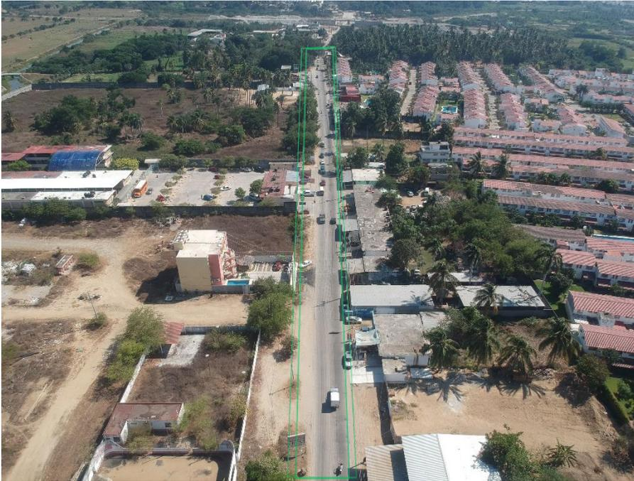
*Fotografía 21. Vista aérea tipo frontal de norte a sur del Km 1+080 al 1+480, en el cual se puede apreciar en color verde el ancho de corona que se pretende ampliar; nótese como el tramo se encuentra inserto en uso de suelo de tipo urbano.*
