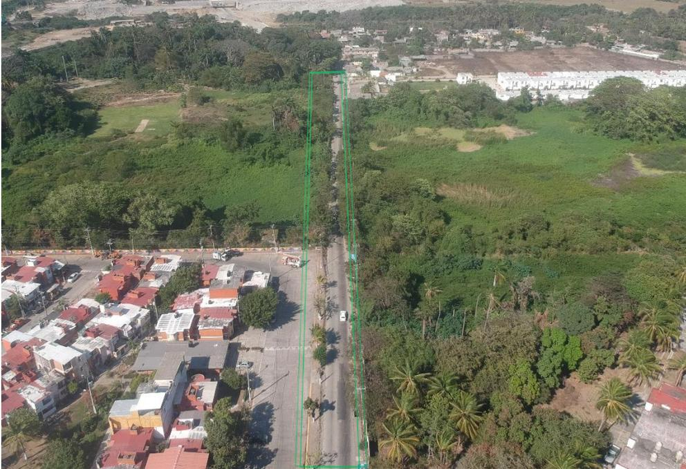
*Fotografía 15. Vista aérea tipo frontal del Km 0+100 al 0+400, en el cual se puede apreciar en color verde el ancho de corona que se pretende ampliar; nótese sobre el lateral izquierdo una vez finalizado el muro del fraccionamiento, se encuentran árboles como cerco vivo dentro del ancho de la vialidad ampliar en un tramo del 0+180 al 0+390.*
