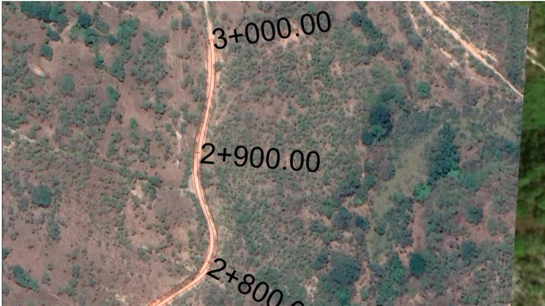
Fotografía 11. Vista satelital tipo plano del Km 3+000 al 2+080, en el cual se puede apreciar el ancho existente del camino que se pretende pavimentar; nótese como en un tramo de casi 200 metros lineales solo se encuentra arboles aislados colindante con el margen del camino, por lo que en algunos casos será necesario podarlos y en casos extraordinarios talarlos.
