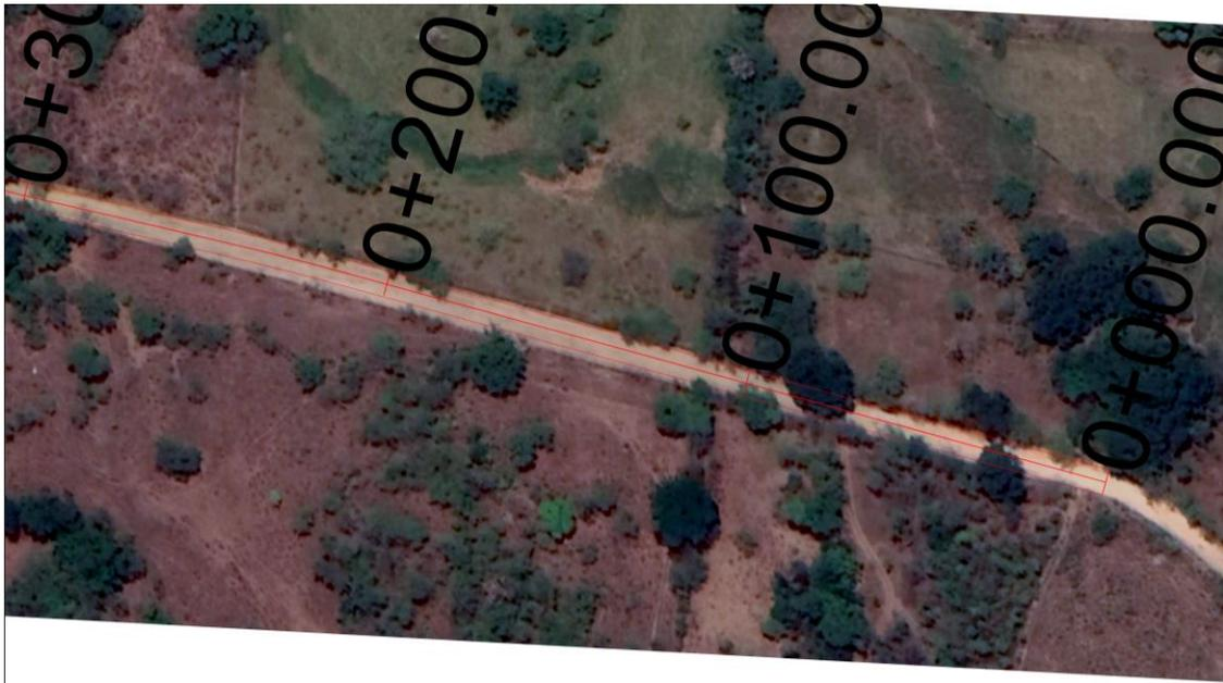
Fotografía 15. Vista aérea del Km 0+000 al 0+300, en el cual se puede apreciar en color rojo el ancho de corona de 7 metros que se pretende pavimentar; nótese como en un tramo de casi 300 metros lineales no se encuentra vegetación forestal primaria dentro del camino, solo se colinda con árboles, arbustos y hierbas ubicadas en los corrales existentes.
