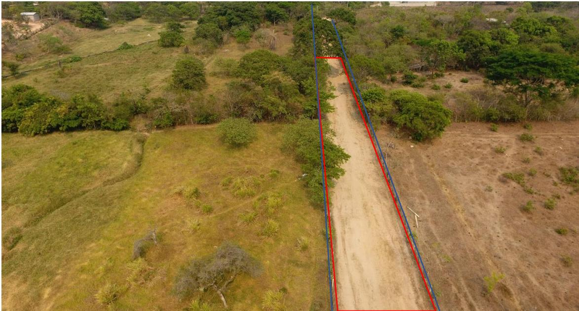
Fotografía 17. Vista aérea oeste a este del Km 0+000, en el cual se puede apreciar ancho de corona de superior a los 7 metros; nótese como en un tramo de casi 55 metros lineales no se encuentra vegetación forestal primaria dentro del camino, solo arbustos y hierbas en los laterales, en los cuales será necesario solo podar algunos individuos.
