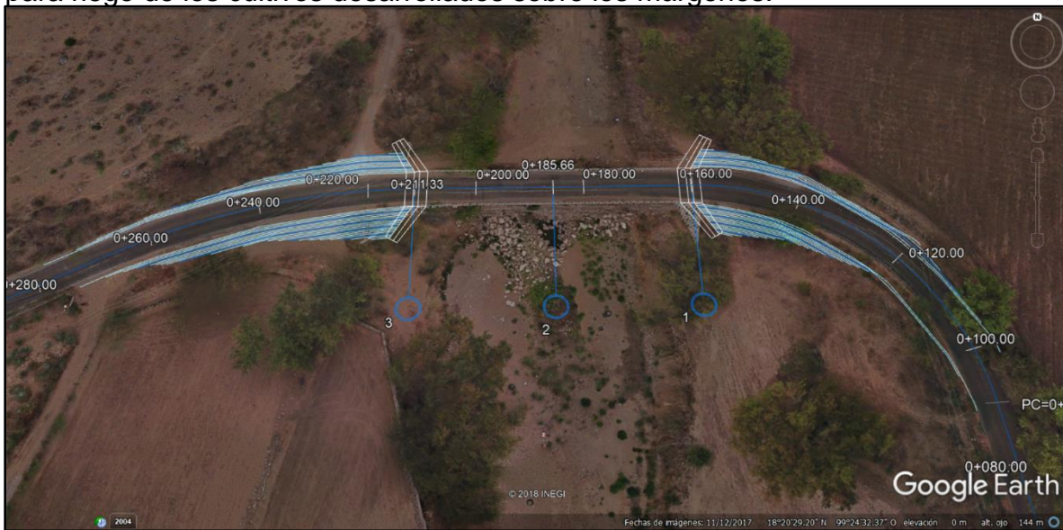
Imagen 3. Ortomosaico elaborado en el 2018 y sobre posicionado en Google Earth, en el cual se puede apreciar las características descritas en el presente apartado; nótese la acumulación de rocas aguas abajo del Puente existente, así como la escasa presencia de árboles donde se pretende desarrollar el proyecto; por lo que dicho puente destaca por su importancia social y económica aunado por los bajos impactos ambientales que generará.
