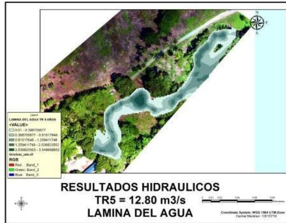
*Figura IV.13 Modelo del escurrimiento del Arroyo Actual, en un Periodo de 5 años, donde se muestran las elevaciones máximas que puede alcanzar dicho cauce*
