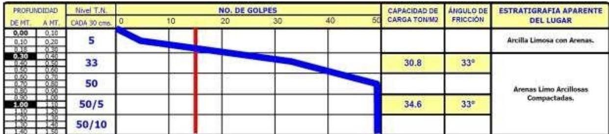
Figura 61. Análisis mecánico del suelo en el sondeo 2 (PPE-02)
