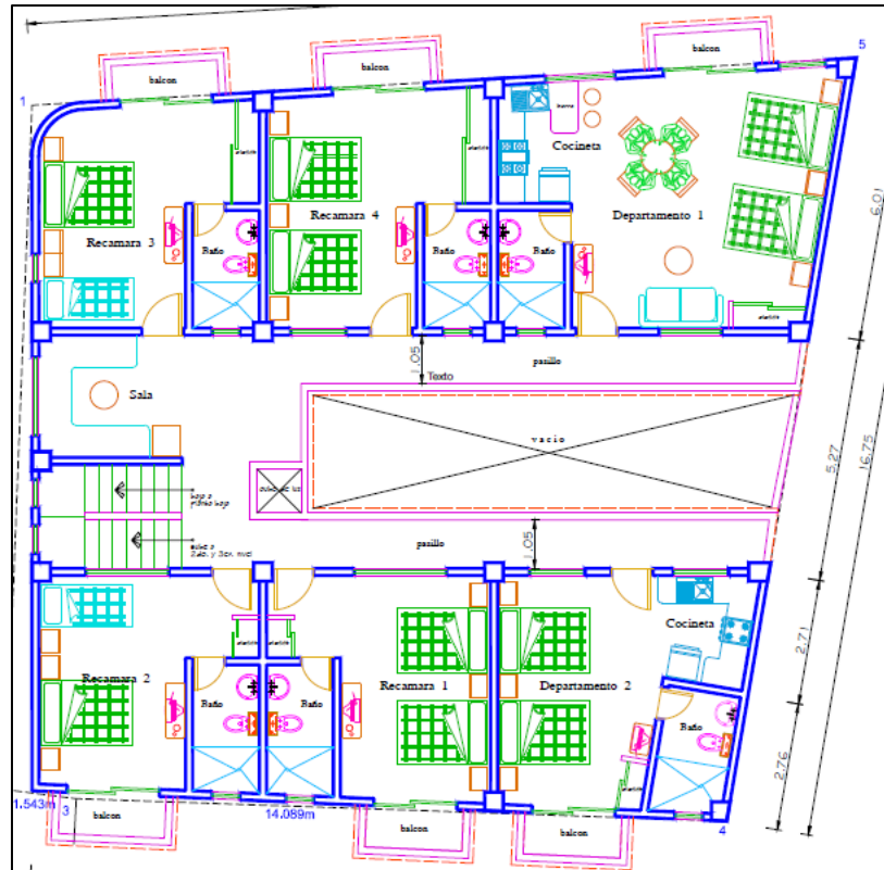
Figura II.11 Planta arquitectónica del nivel 1, 2 y 3.
