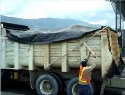
Ilustración 1 Colocación de lona (enlonado de camiones de transporte de material)
