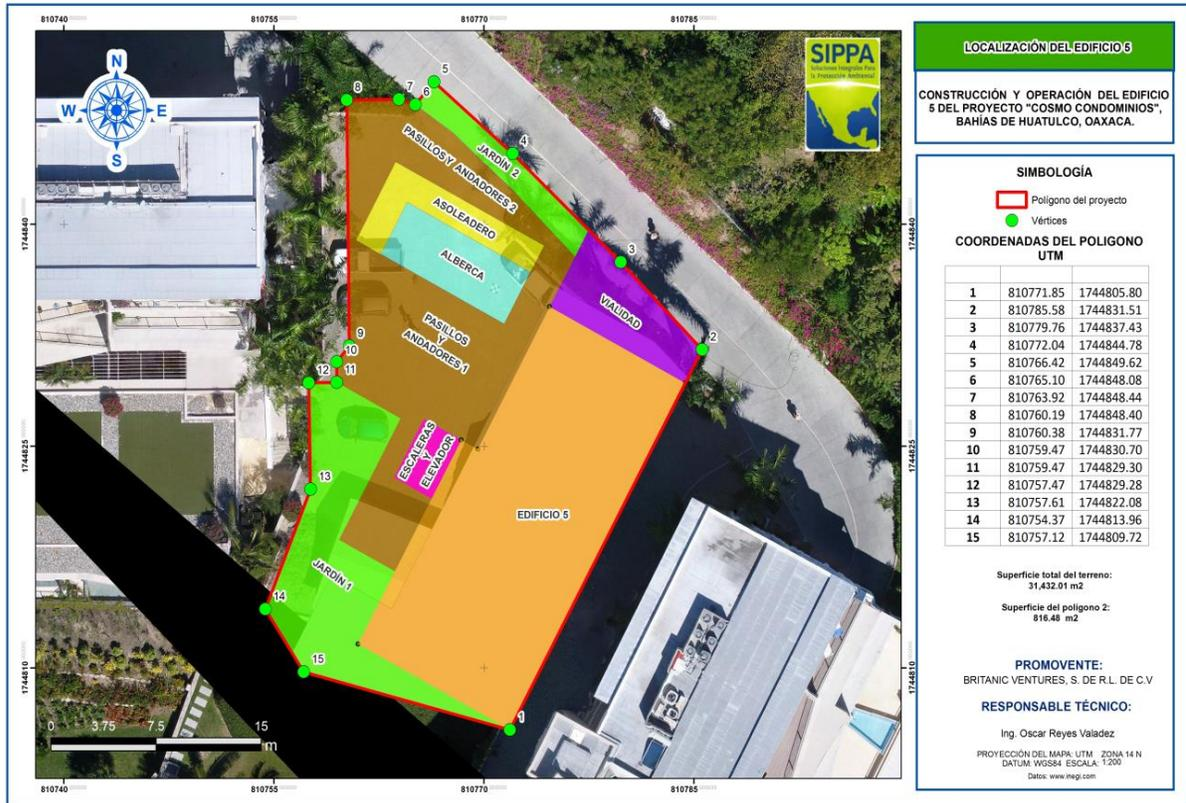
Imagen 7. Distribución de las áreas que conforman el edificio 5.
