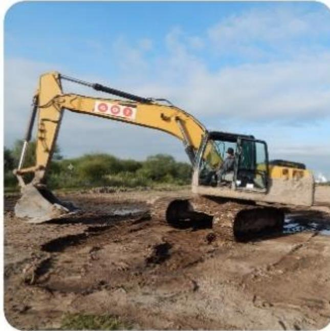
**Imagen 9.** Ejemplo de la maquinaria para llevar a cabo el despalme.
