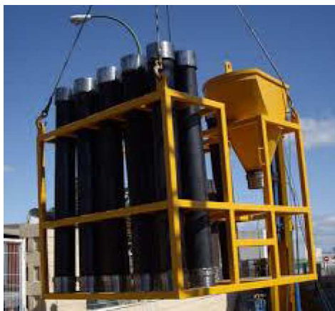
Figura 2. 29. Ejemplo de tubería tremie.
