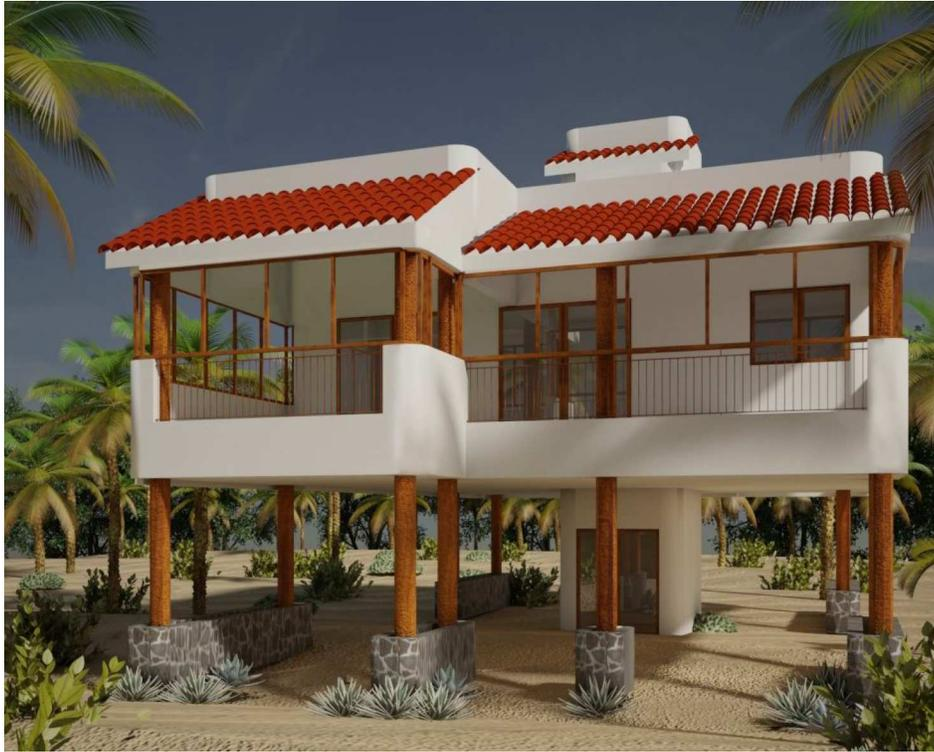
**Figura 14.-** Perspectiva (modelo computarizado) de la cabaña propuesta en el proyecto, en esta imagen se observan claramente que la cabaña se integra solamente de planta baja, así como el piloteado para estar por encima del nivel medio del mar a cuando menos 2.5 metros.
