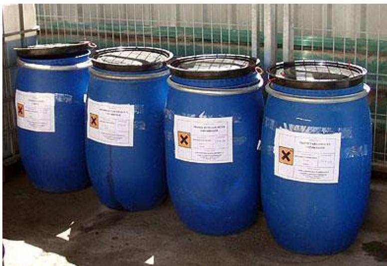
**Fig. 64.-** Ejemplo de botes y señalización tipo a utilizar en la etapa operativa del proyecto para el confinamiento temporal de residuos que por su naturaleza se consideren como peligrosos.
