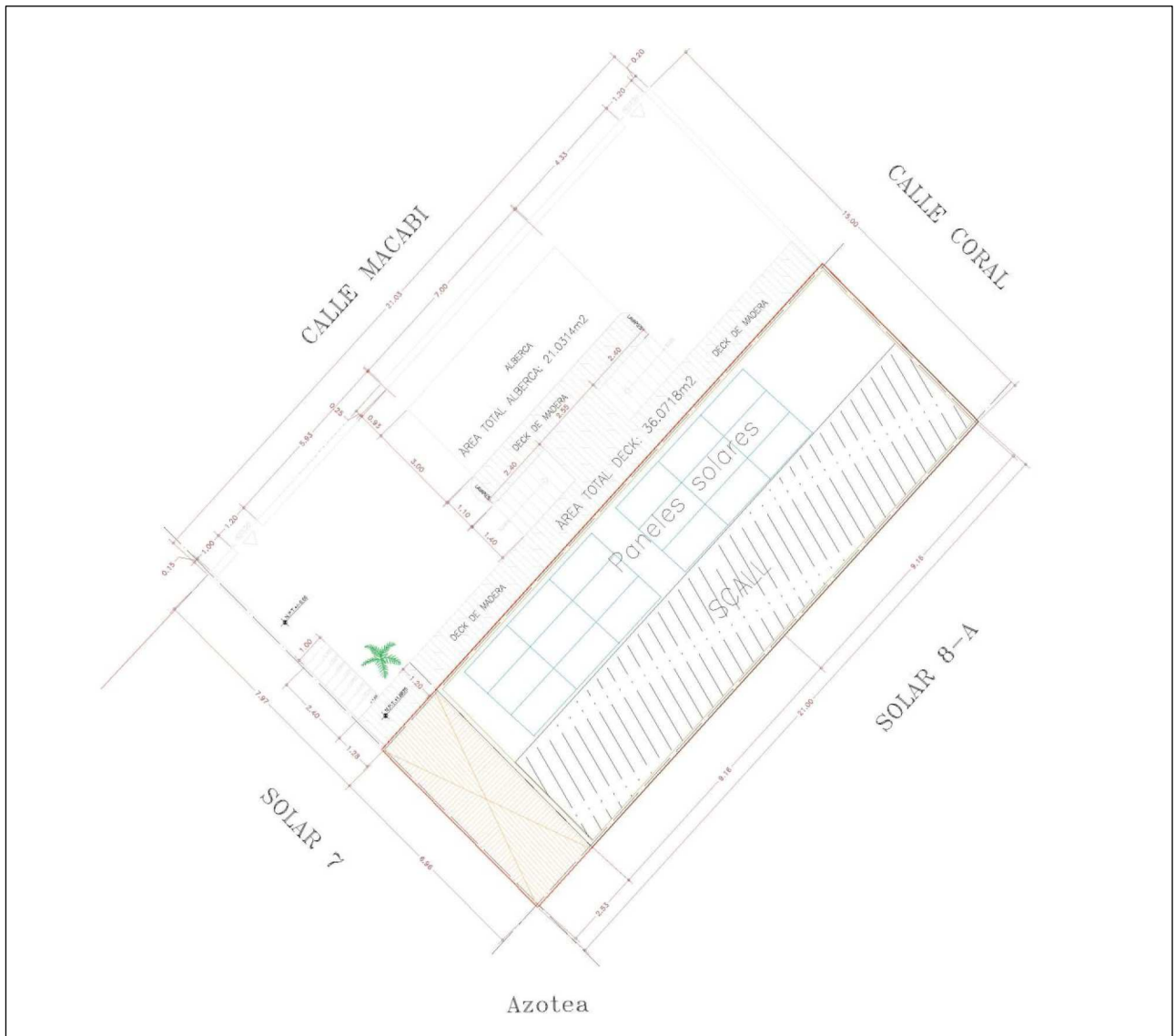
Figura 10 . Plano del área del techo donde se observa el área destinada para el Sistema de Captación de Agua de Lluvia (SCALL) con una superficie de 63.40 m 2
