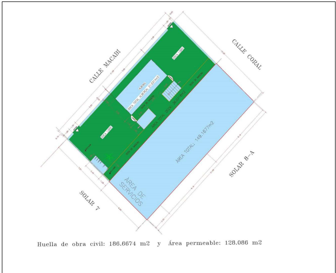
Figura 5. Huella de desplante del proyecto sobre la superficie del terreno en color azul. Área permeable en color verde.
