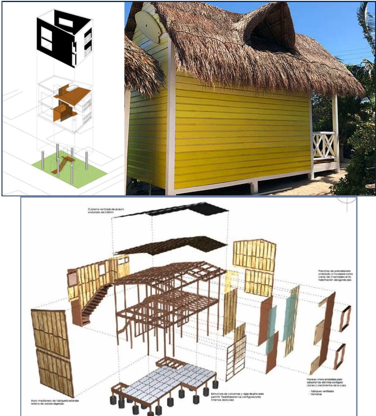
Figura 10. Proceso de ensamblaje de las edificaciones propuestas para el proyecto.
