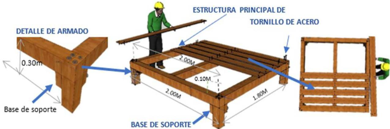
**Figura 2.9.** Representación gráfica de la construcción de los camastros.
